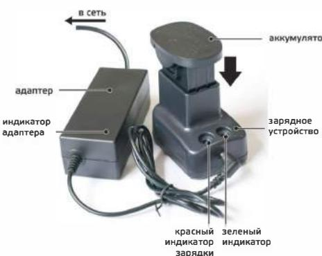
1. Полностью вставьте аккумулятор в зарядное устройство в соответствии со знаками анода и катода. Убедитесь, что аккумулятор плотно закреплен. Соедините адаптер с зарядным устройством и подключите к розетке с напряжением 220-240 В.
